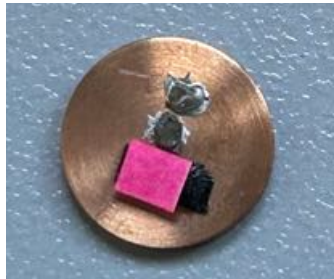
Figura 3.2: Fotografia del campione di ScV_6Sn_6 fissato sulla placca di rame. Il campione utilizzato è il secondo dall'alto.
