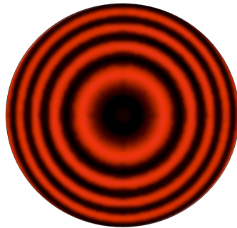
Figura 1.2: Figura d'interferenza visualizzabile in una sperimentazione con un interferometro di Michelson ed un laser nel visibile a simmetria gaussiana.
