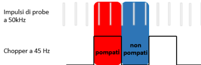
Figura 20: Schema per l' acquisizione dei dati con un chopper meccanico. Adattato da [13].
